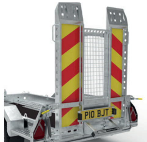
○ Markeringsborden op de achterzijde en versterkte midden segment tussen de rijplaat combi.
